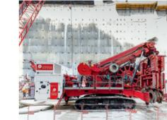
**Hidrofresa® HC05:** Compacta y transportable en contenedores, la Hidrofresa® HC05 es ideal para los entornos altamente restringidos, bajo altura limitada. Puede ser equipada con un power pack eléctrico para reducir su huella de carbono y con codales para más rendimiento.
