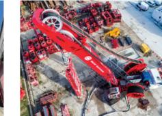
**Hidrofresa® HF8:** Un equipo capaz de excavar los terrenos más duros alcanzando grandes profundidades. Este equipo puede ser transportado en contenedores y se desmonta en 72h. La Hidrofresa® HF8 puede ser equipada con codales y con power pack eléctrico.
