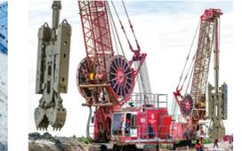
**Cuchara KS / Baya grab:** Silenciosa y provocando pocas vibraciones, está perfectamente adaptada a las obras urbanas. Las últimas generaciones están equipadas con guías hidráulicas y sensores electrónicos para una mejor precisión y verticalidad de la excavación.
