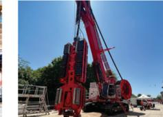
**Hidrofresa® HF6:** Capaz de alcanzar los 90m de profundidad mientras ocupa una superficie reducida. La Hidrofresa® HF6 responde a las necesidades de las obras urbanas actuales. La HF6 cuenta con codales y puede funcionar con electricidad.
