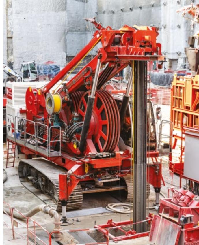
Hydrofraise® compacte à Grippeurs électrique
