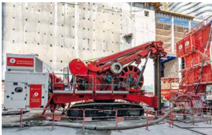
Le dernier cri des machines de forage : plus performante, plus discrète et plus écologique, l'Hydrofraise® Compacte à Grippers électrique a été utilisée par Soletanche SAM sur le chantier de Testimonio II. Une première en Europe continentale.
