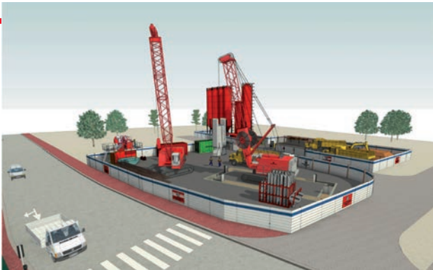
Vue 3D des installations de chantier de paroi moulée sur l'ouvrage EcoQuartier
