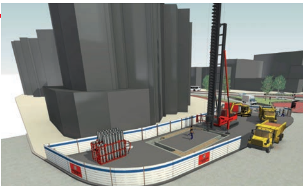
Vue 3D des installations de chantier de pieux sécants sur l'ouvrage Résistance
