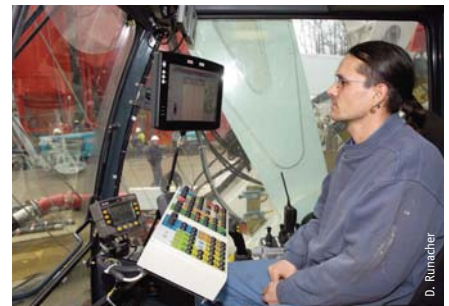
Cabine de pilotage de l'hydrofraise, équipée du système Enpafraise
